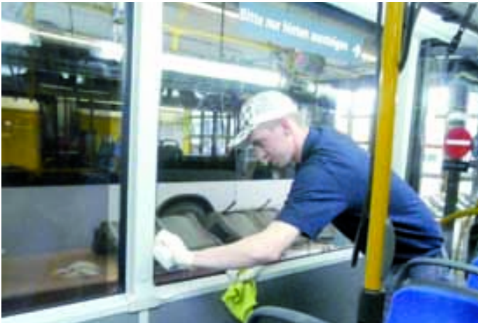
Gegen »Fettköpfe« an den Fenstern hilft eine Schicht, die zwei Mal im Jahr erneuert werden muss. Der Schutzlack würde die Scheiben milchig werden lassen.
